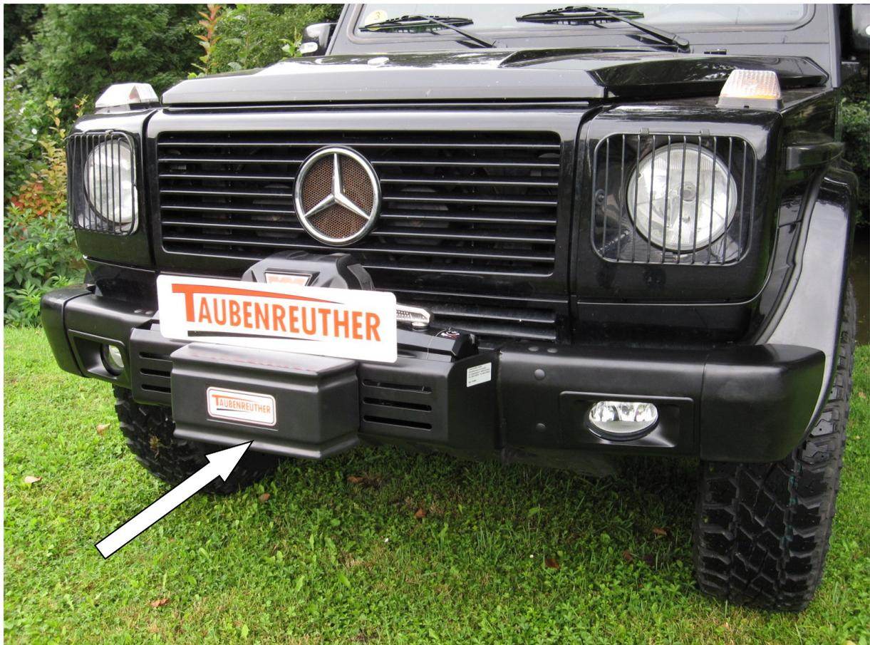
**Hier sehen sie den fertig montierten Seilwindenanbausatz.
